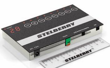
Основное применение: передача речи кассира с переговорного устройства Stelberry S-423 на слуховой аппарат, находящийся в режиме «Т»
